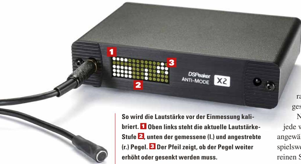
So wird die Lautstärke vor der Einmessung kalibriert. **1** Oben links steht die aktuelle Lautstärke-Stufe **2**, unten der gemessene (l.) und angestrebte (r.) Pegel. **3** Der Pfeil zeigt, ob der Pegel weiter erhöht oder gesenkt werden muss.
