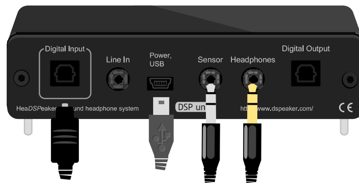
DSP-yksikön kytkentä digitaaliseen äänilähteeseen
